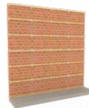
Houten latten rechtstreeks op de muur
